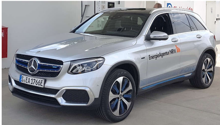
Mercedes GLC Brennstoffzelle als Range-Extender (REX), 430 (350) km Reichweite (+50 km mit Batterie), 2,1 to (Mercedes EQC, 450 km Reichweite, 2,5 to)
