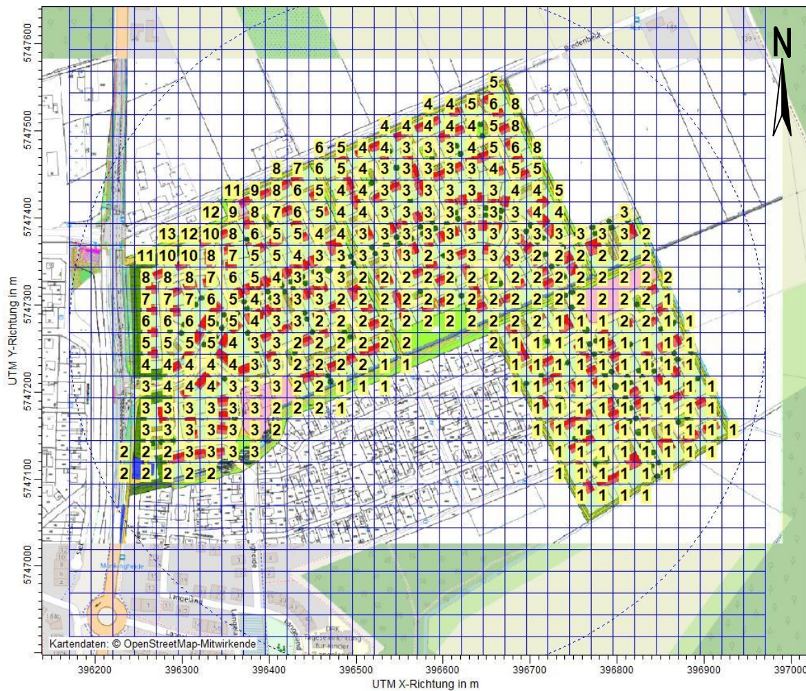
Abbildung 3: Variante 2: Gesamtbelastung IG_b durch zwei Hofstellen (westliche Hofstelle + östliche Hofstelle mit 20 Pferden) in % der Jahrestunden, Seitenlänge: 25 m
