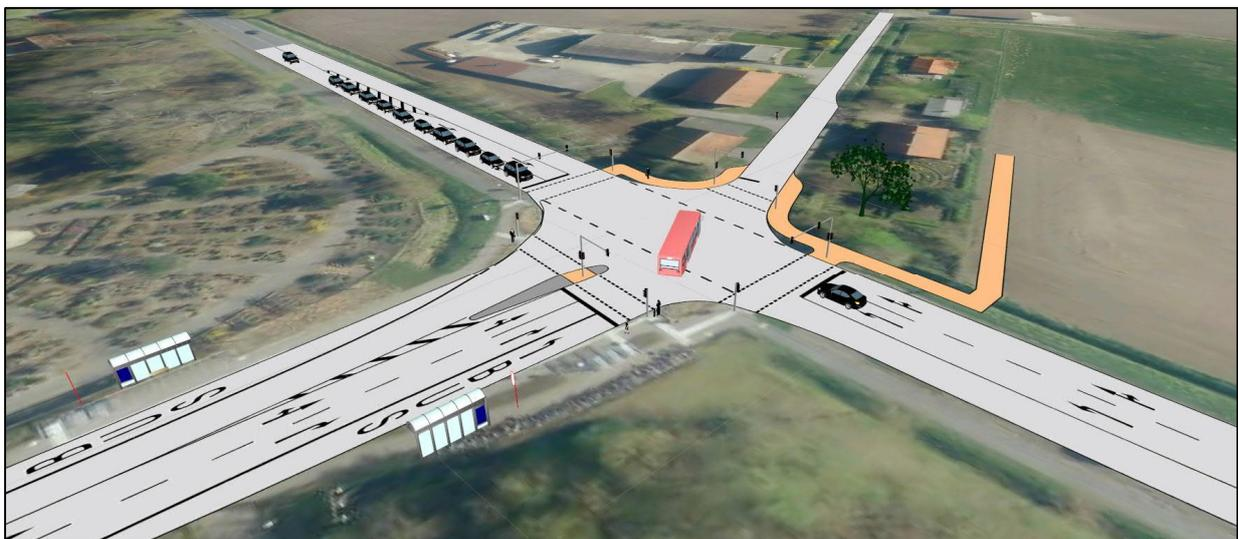
Abbildung 15: Planfall P3 Nachmittagsspitze – Separate Freigabe des Busses aus der Haltestelle in der L 844
