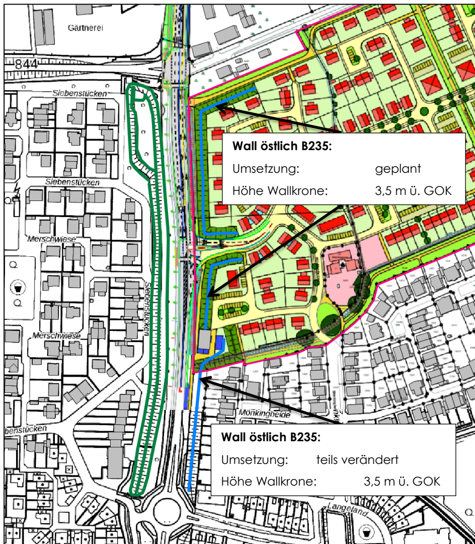
Abbildung 8: Aktive Lärmschutzmaßnahmen für den Prognose-Planfall 2030, Variante 1
