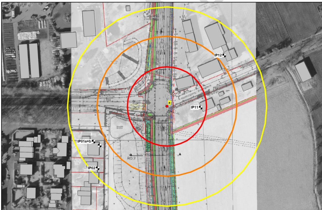
Abbildung 5: Zuschlag für die Störeinwirkung an lichtzeichengeregelter Kreuzung im Prognose-Planfall 2030 für den Kreuzungsbereich Knotenpunkt B235/L844; rot: + 3 dB(A), orange: + 2 dB(A), gelb: + 1 dB(A)
